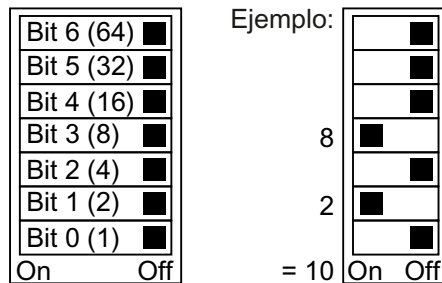
Figura 4-46 Interruptor de direcciones con ejemplo para la dirección de bus 10
