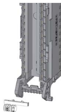
Figura 9-5 Colocación del elemento codificador en el conector frontal
